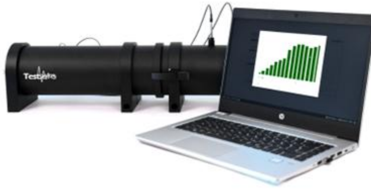
Şekil 8. Dört mikrofonlu empedans tüp (Özgür, 2023)
