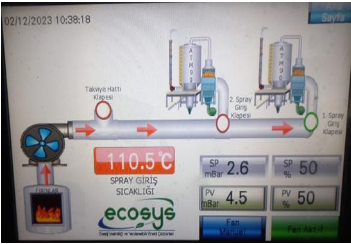
Şekil 3. Kurutma Atık Isı Geri Kazanım Kontrol Panosu Üzerinde, Sistemin İzlenmesi
